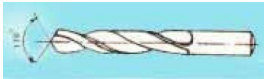
Gambar 30. Bagian-bagian mata bor
