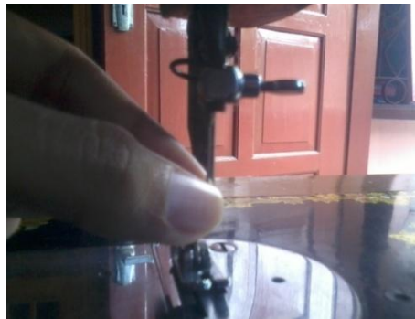
Gambar 3. Memasang Jarum Mesin
