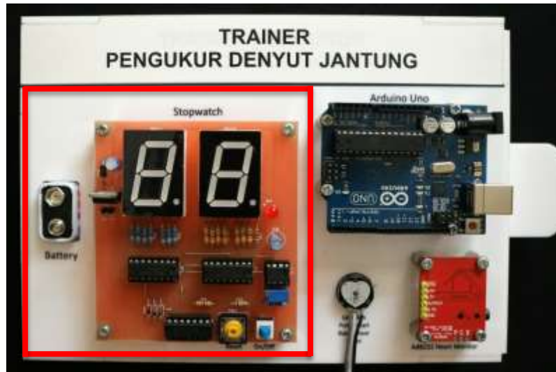
Gambar 43. Produk Akhir Trainer Kit Pengukur Denyut Jantung dengan Metode Palpasi
