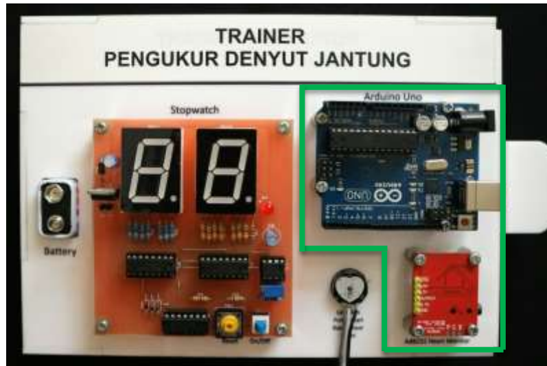
Gambar 45. Produk Akhir Trainer Kit Pengukur Denyut Jantung dengan Metode Electrocardiography (ECG)
