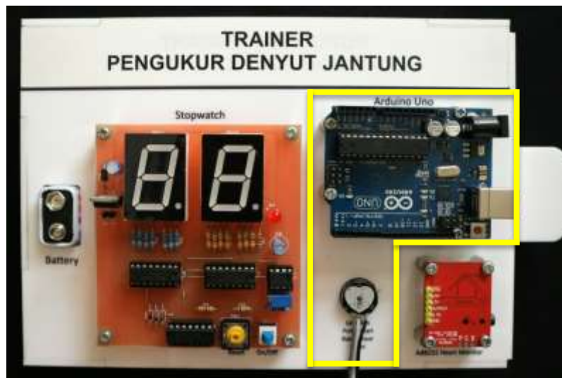
Gambar 44. Produk Akhir Trainer Kit Pengukur Denyut Jantung dengan Metode Photoplethysmography (PPG)
