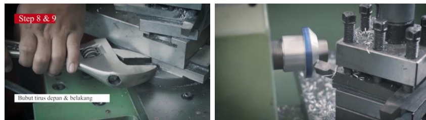
Gambar 27. Step 8 dan 9 proses pembuatan tirus.
