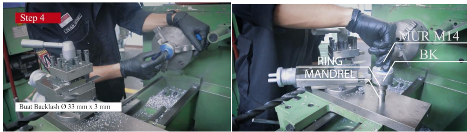
Gambar 23. Step 4 proses pembuatan backlash blank roda gigi payung.
