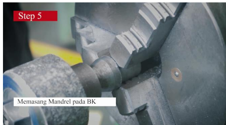
Gambar 24. Step 5 proses pemasangan mandrell.
