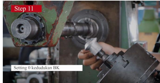
Gambar 29. Step 11 proses setting kedudukan benda kerja.
