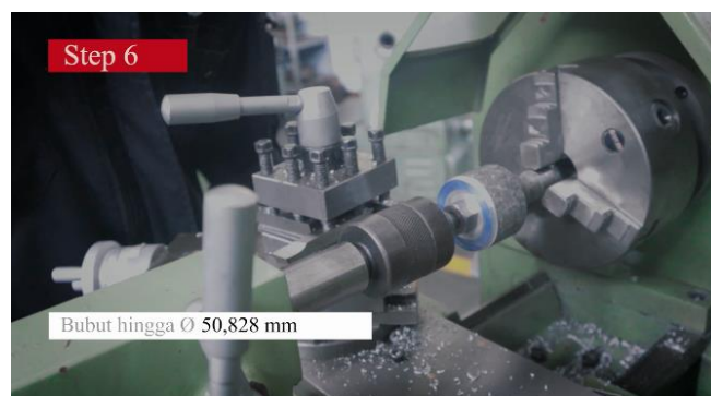
Gambar 25. Step 6 proses pembubutan memanjang.
