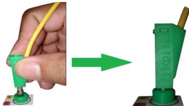
Gambar 31. Pemasangan Kabel Jumper
