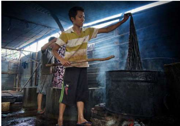
Gambar 63. Proses melepaskan lillin dari kain dengan cara direbus
