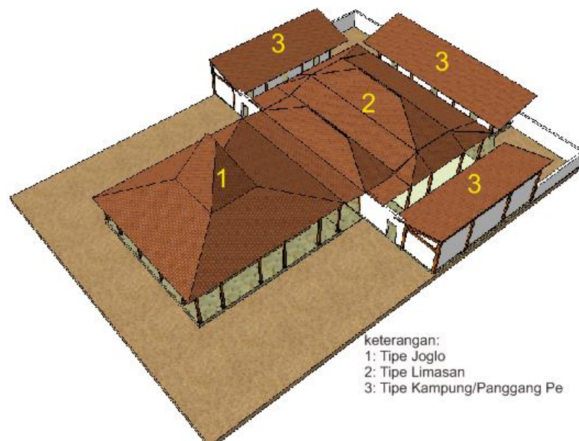
Gambar 22. Ilustrasi Jenis Atap pada Rumah Joglo Sumber: Rizqi Allam (2018)
