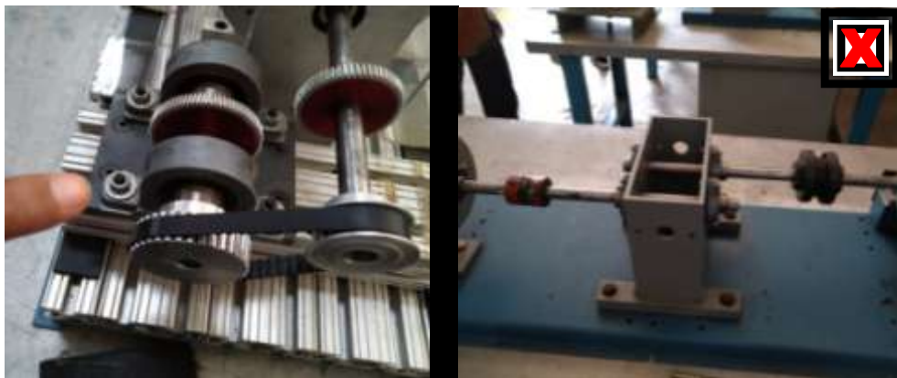
Gambar 10. Modul Rotari Gear tanpa pelindung
