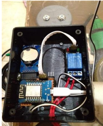
Gambar 3. Pemasangan Elektronika pada Black Box
