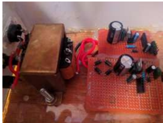
Gambar 24. Rangkaian Pada Catu Daya Variabel
