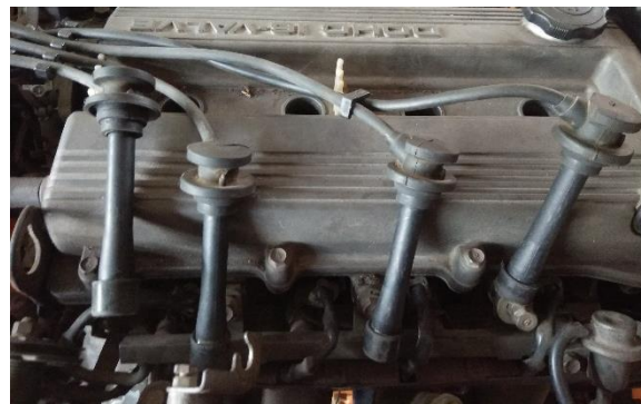
Gambar 4. Kabel tegangan tinggi
