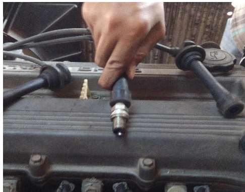
Gambar 13. Pengujian percikan api pada busi
