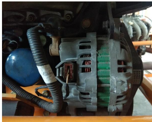
Gambar 8. Pemeriksaan secara visual sistem pengisian
