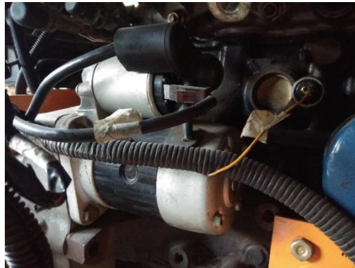
Gambar 9. Pemeriksaan secara visual sistem starter
