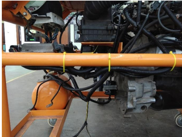
Gambar 11. Pemasangan kabel jaringan kelistrikan
