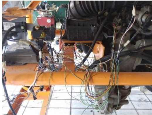
Gambar 4. Kondisi Jaringan Kabel Engine Stand Timor S515i T2
