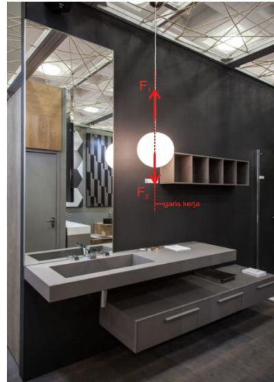
Gambar 13. Sebuah lampu yang digantungkan dengan seutas kabel sering kita jumpai dan merupakan salah satu contoh gaya yang kolinier.
