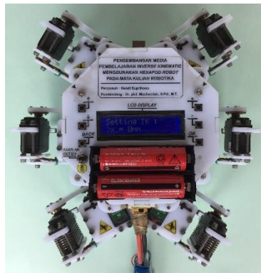
Gambar 42. Kaki Robot pada Posisi Awal 30°
