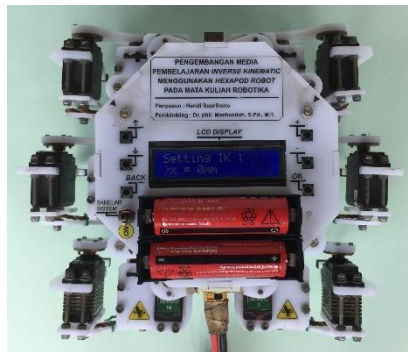
Gambar 40. Kaki Robot pada Posisi Awal 0°
