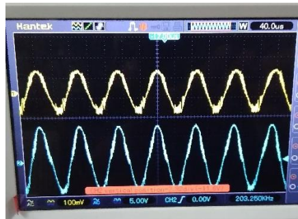
Gambar 28. Penguatan Tegangan Amplifier OCL
