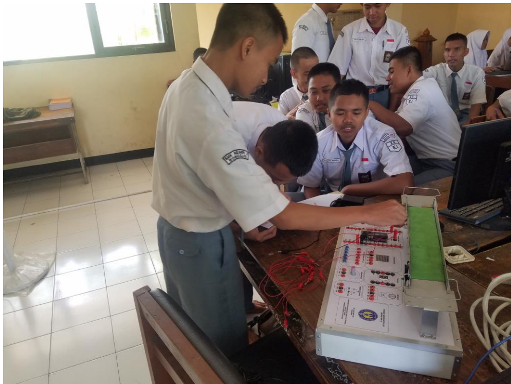
Siswa di untuk merangkai kabel dari Arduino UNO R3 ke input/output trainer sesuai dengan jobsheet .
