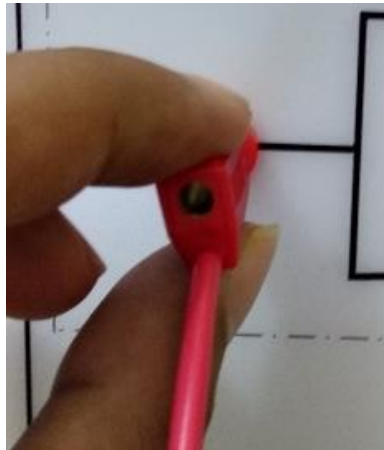
Gambar 8. Cara memasukan kabel jumper
