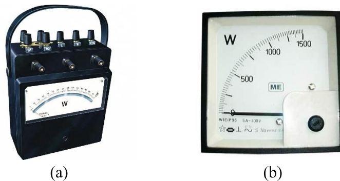
Gambar 11. Jenis wattmeter (a) wattmeter portabel satu fase; dan (b) wattmeter industri (Sumber: (a) Agarwal,2018 dan (b) Nvis, 2017)
