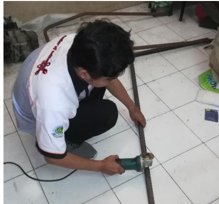
Gambar 3. Proses pemotongan besi hollow
