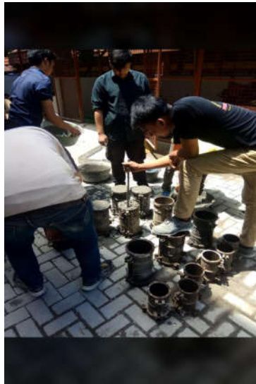
Proses pemadatan benda uji.
