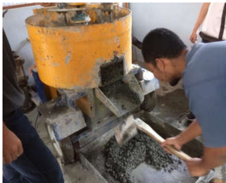
Proses penuangan beton segar.
