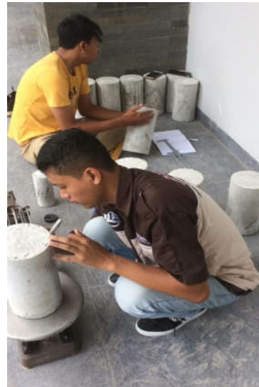
Proses penimbangan benda uji.
