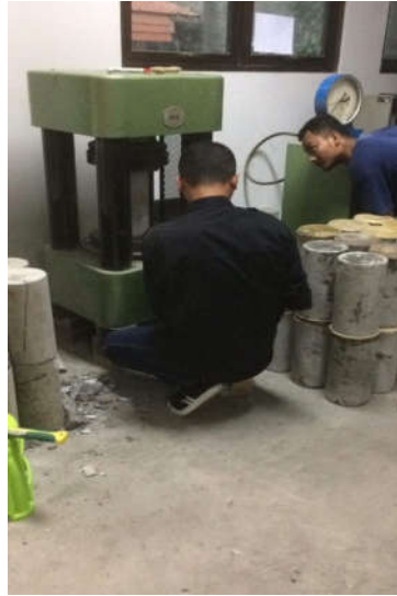
Gambar 5. Pengujian kuat tekan silinder beton.
