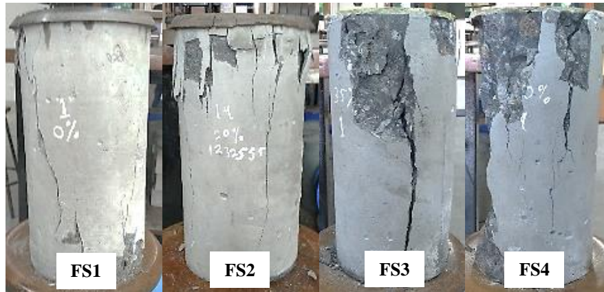
Gambar 51. Benda Uji Beton setelah Pengujian Tekan
