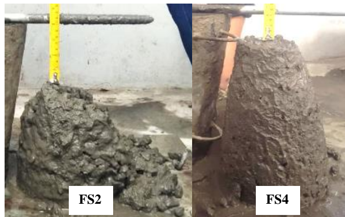
Gambar 48. Campuran Beton Segar saat Pengujian Slump
