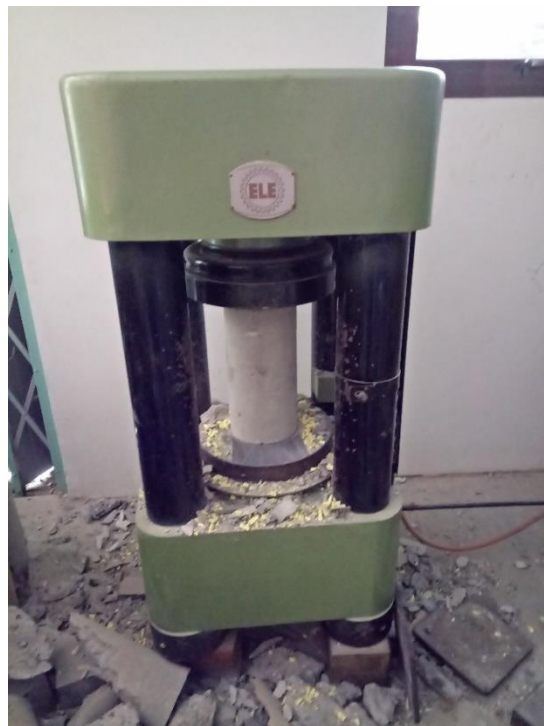
Gambar 33. Pengujian Silinder Beton
