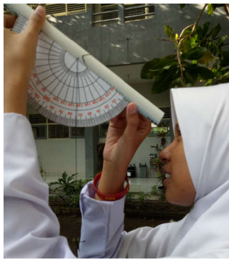
Gambar 13. Peserta didik Menggunakan Klinometer untuk Mengumpulkan Data
