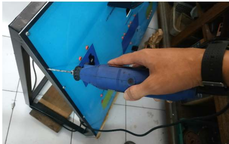
Gambar 17. Proses Melubangi Akrilik dengan Bor Tangan
