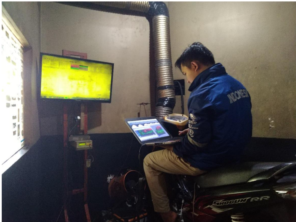
Lampiran 5. Proses Pengujian Performance mesin menggunakan Dyno Test
