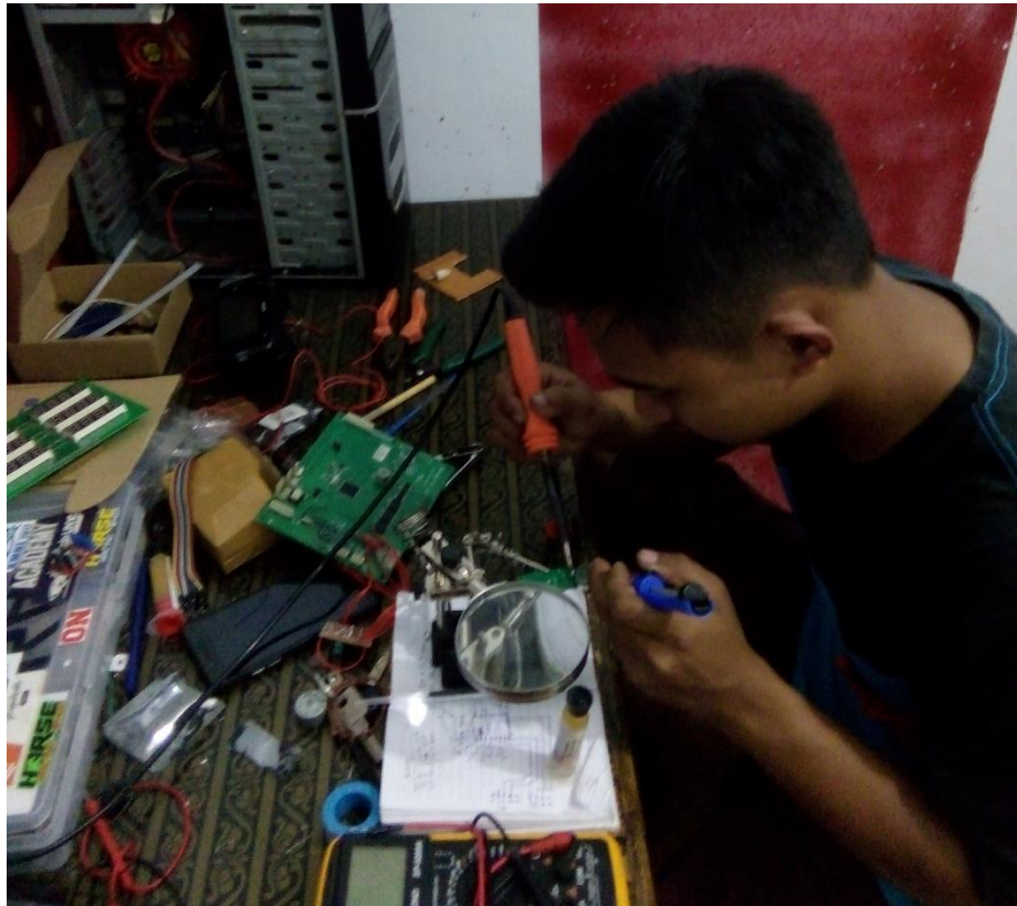
Lampiran 4. Proses Perakitan ECU Programmable pada Papan PCB
