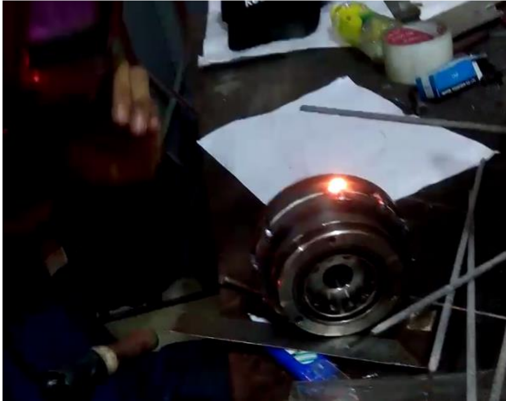
Lampiran 8. Pembuatan Pick Up (gigi tonjolan 12-1) pada Rotor Flywheel
