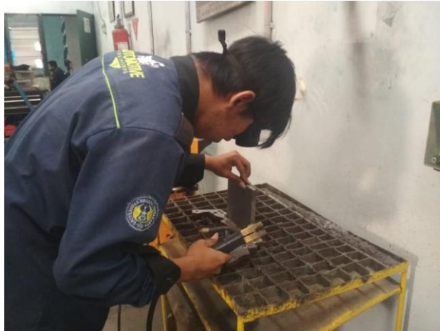
Gambar 7. Proses pengelasan sambungan dengan dudukan
