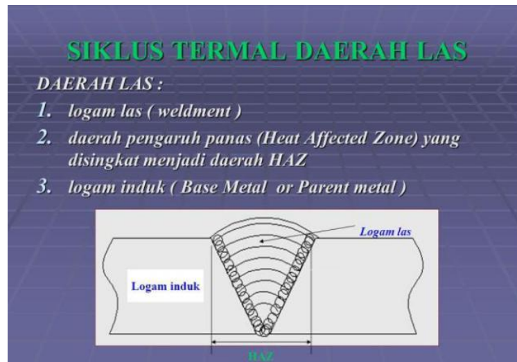
Gambar 9. Siklus termal disekitar lasan dengan kondisi
