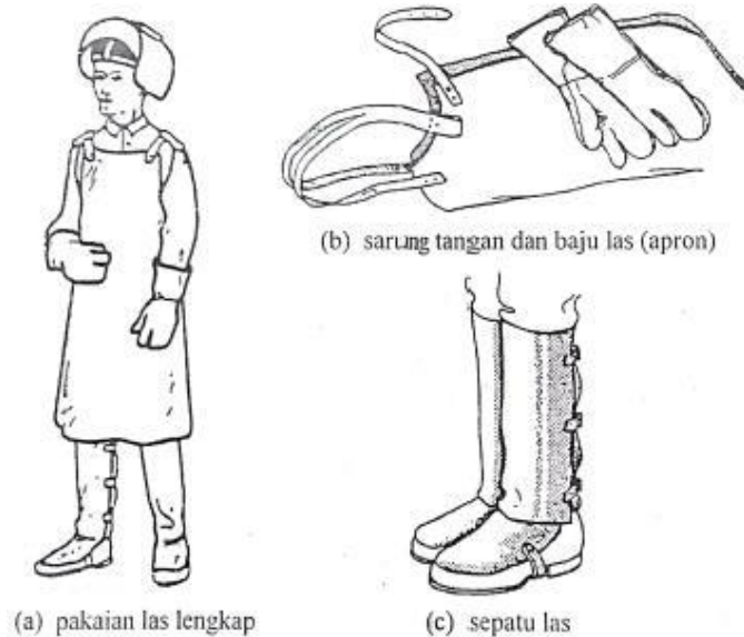
Gambar 14. Perlengkapan Keselamatan Kerja Pengelasan Perlengkapan keselamatan kerja pengelasan yang digunakan , sebagai berikut :
