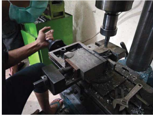
Gambar 51. Pengikisan kampas rem
