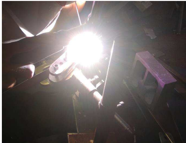
Gambar 50. Pengelasan dudukan kaliper dengan upright
