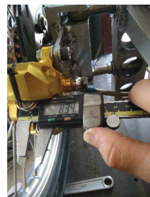
Gambar 76. Pengukuran celah kampas rem roda depan kiri.
