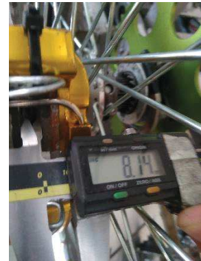
Gambar 77. Pengukuran celah kampas rem roda depan kanan.
