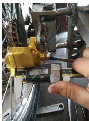
Gambar 76. Pengukuran celah kampas rem roda depan kiri.
