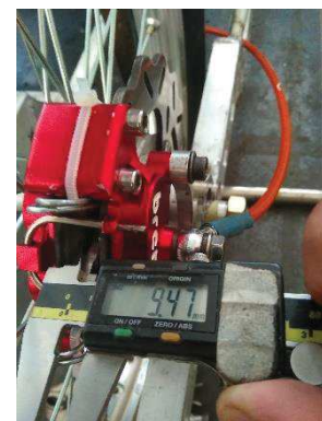
Gambar 79. Pengukuran celah kampas rem roda belakang kanan.
