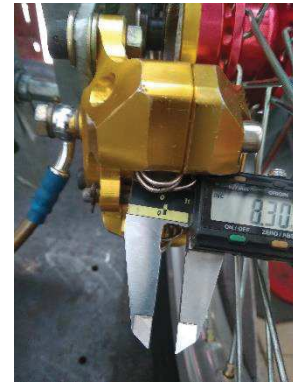
Gambar 78. Pengukuran celah kampas rem roda belakang kiri.
