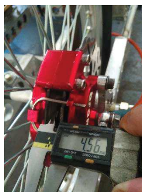
Gambar 79. Pengukuran celah kampas rem roda belakang kanan.
