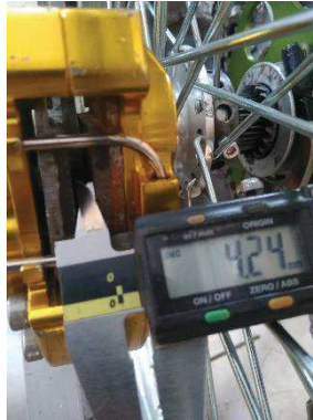
Gambar 77. Pengukuran celah kampas rem roda depan kanan.
