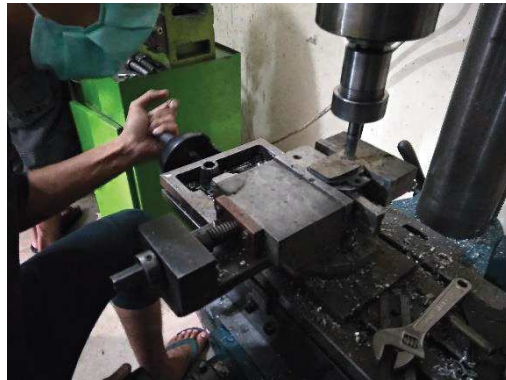
Gambar 63. Pengikisan kampas rem
