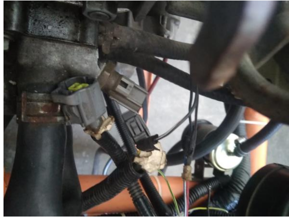
Gambar 30. Melepas konektor dari switch temperature air
