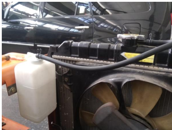
Gambar 33. Recervoir tank setelah terpasang ke radiator
