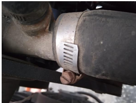
Gambar 32. Pemeriksaan selang radiator secara visual
