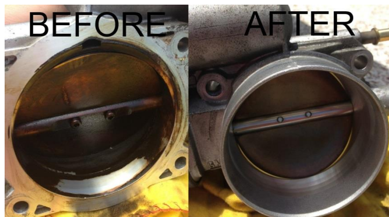
Gambar 13 Throttle Body Yang Sudah Dan Belum Dibersihkan
