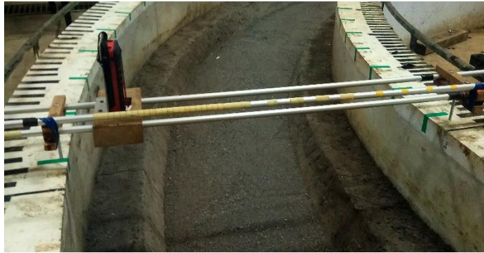
Gambar 18. Alat Bantu Pengukuran Kedalaman Saluran (Dokumentasi Pribadi, 2019)
