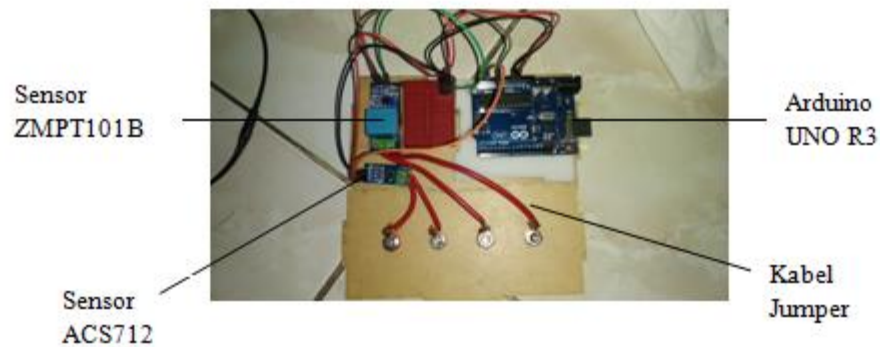
Gambar 24. Sistem Monitoring Picohydro Portable Berbasis Arduino Tampak Dalam
