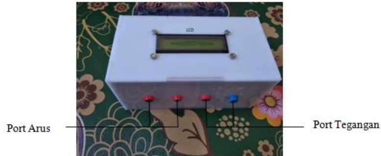
Gambar 23. Sistem Monitoring Picohydro Portable Berbasis Arduino Tampak Luar
