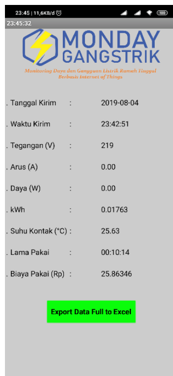
Gambar 45. Aplikasi MONDAY GANGSTRIK Yang Merupakan Media Untuk Monitoring Alat berbasis internet of things
