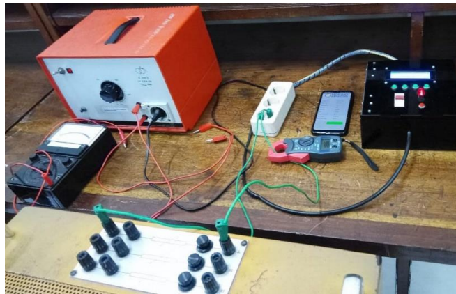
Gambar 35. Pengujian Alat Sebagai Pengaman Over Current
