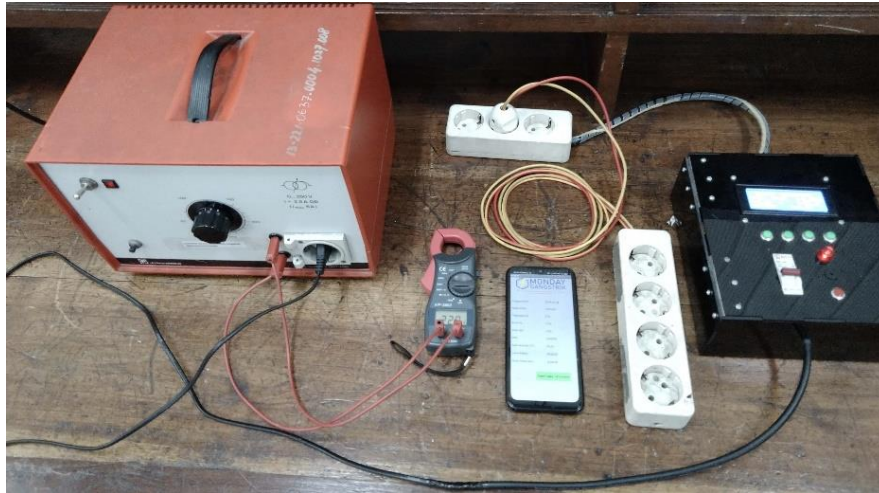
Gambar 37. Pengujian Alat Sebagai Pengaman Under Upper Voltage
