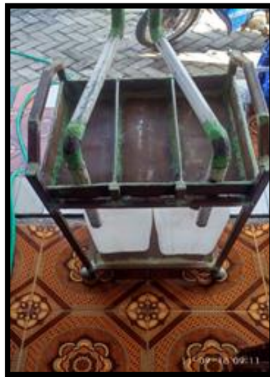
Gambar 26. Proses pendempulan alat penampung oli
