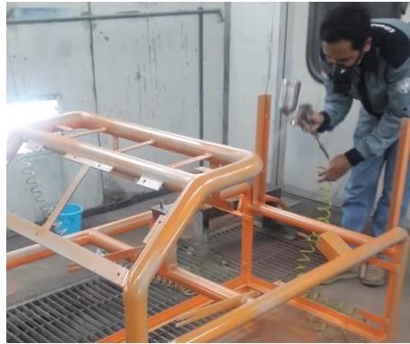
Gambar 11. Proses Pengecatan Warna
