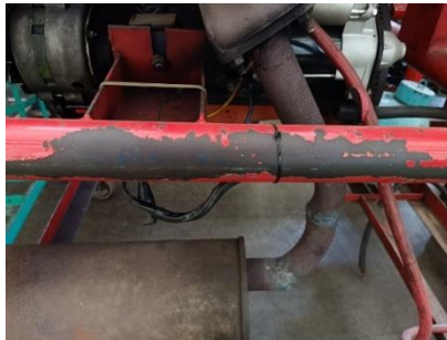
Gambar 3. Kondisi rangka yang berkarat
