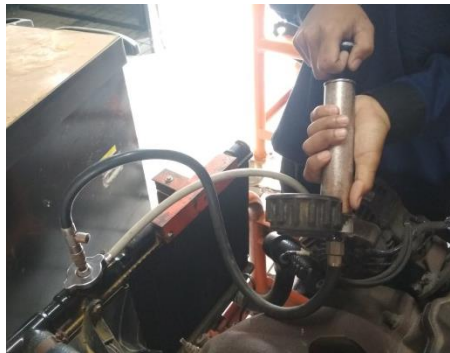
Gambar 4. Memeriksa Kebocoran Sistem Pendingin
