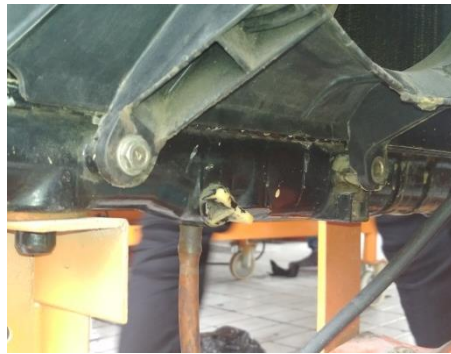
Gambar 16. Menutup Saluran Kuras Radiator
