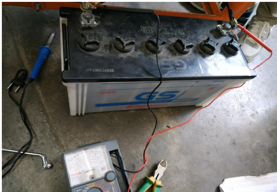
Pengujian tegangan pengisian baterai
