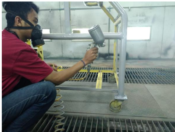
Gambar 10. Proses awal penyemprotan lapisan epoxy
