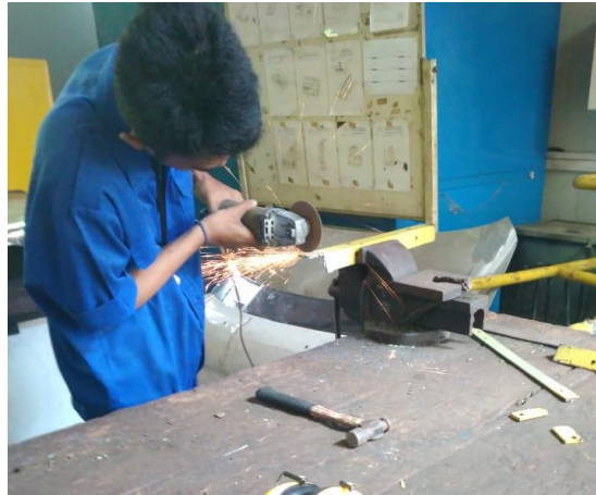
Gambar 6. Proses meratakan bagian awah dudukan
