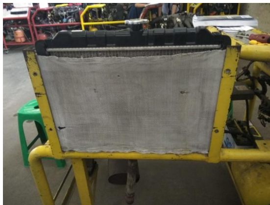
Gambar 3. Posisi dudukan radiator yang berada di luar rangka utama
