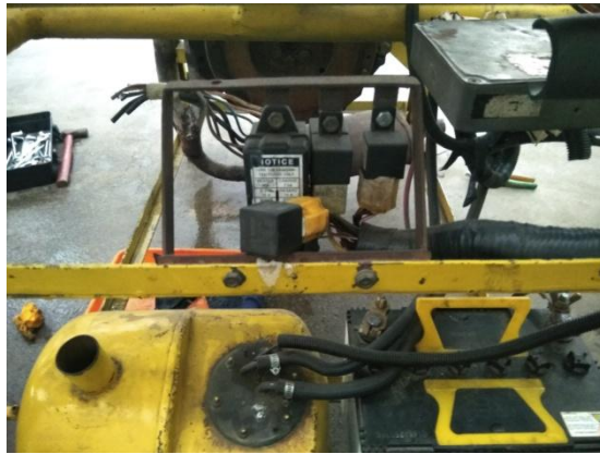
Gambar 4. Posisi dudukan awal relay dan fuse
