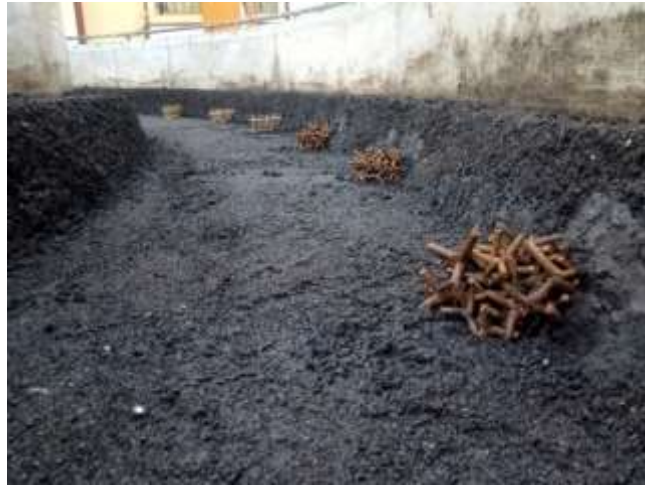
Gambar 67. Tetrapod Pada Model Sungai
