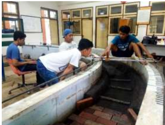
Gambar 65. Pembacaan Kedalaman Gerusan menggunakan Distometer
