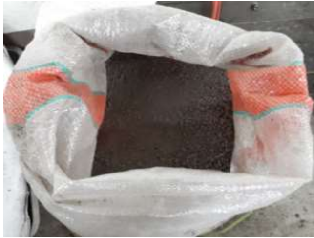
Gambar 70. Bahan Utama Pembuatan Model Sungai Tanah lolos saringan #4
