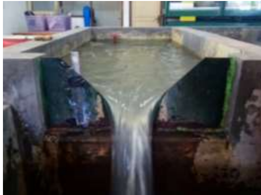
Gambar 16. Peluap segitiga model Thompson (Sumber: Dokumentasi Pribadi, 2019)
