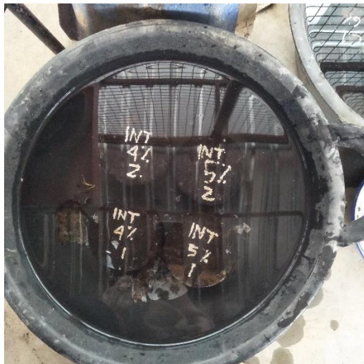
Gambar 42. Perendaman benda uji
