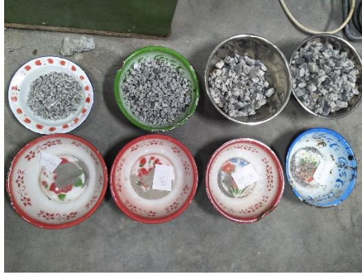
Gambar 38. Pengujian gradasi agregat kasar
