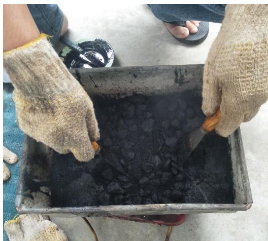
Gambar 40. Pemanasan campuran aspal
