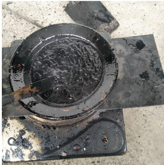
Gambar 39. Pemanasan aspal dan getah karet
