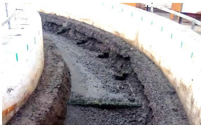
Gambar 43. Kondisi tengah belokan sungai dengan FP1 (Sumber: Dokumen Pribadi, 2019)
