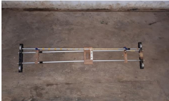
Gambar 26. Alat bantu pembacaan kedalaman saluran (Sumber: Dokumentasi Pribadi, 2019)
