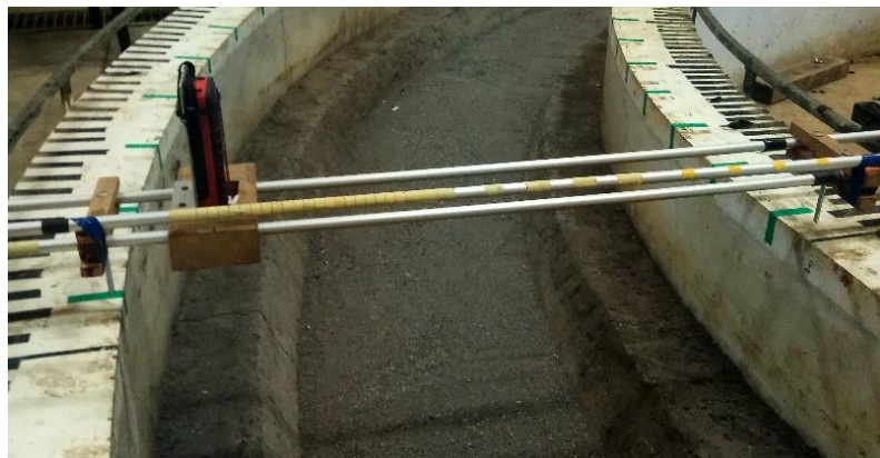
Gambar 25. Proses pengukuran kedalaman saluran (Sumber: Dokumentasi Pribadi, 2019)
