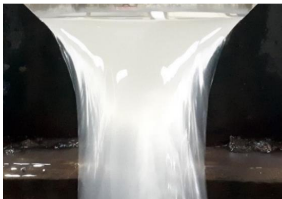
Gambar 17. Aliran air pada peluap segitiga (Sumber: Dokumentasi Pribadi: 2019)
