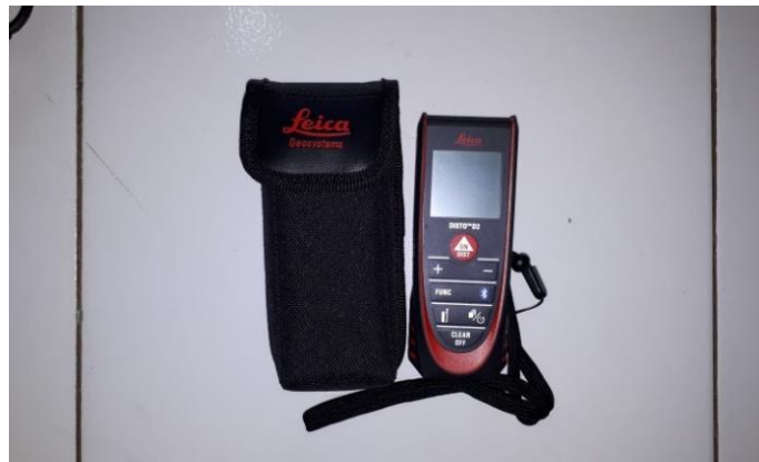
Gambar 24. Leica distometer D210 (Sumber: Dokumentasi Pribadi, 2019)
