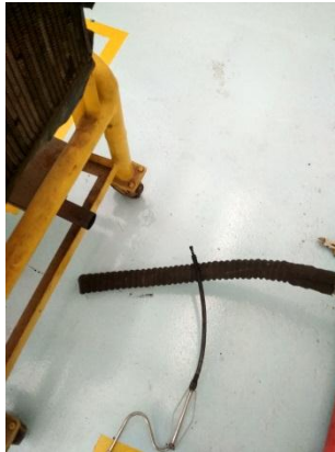
Gambar 14. Pengujian Gas Buang tanpa exhaust blower
