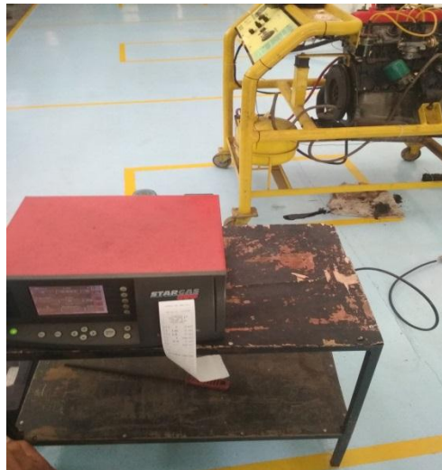
Gambar 13. Mengeprint hasil pengukuran gas
