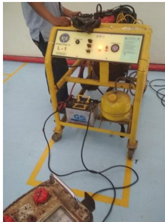
Gambar 17. Menyalakan engine stand selama 5-7 menit dengan exhaust blower hidup
