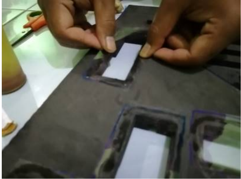
Gambar 13. Menambahkan Laminasi pada Stiker
