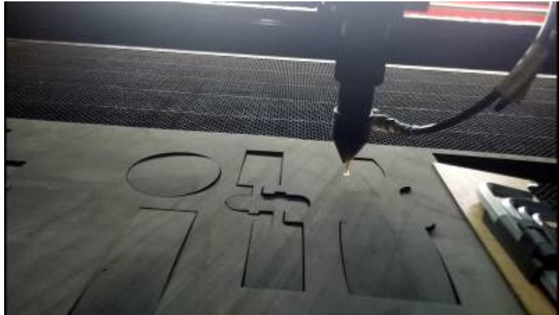
Gambar 7. Proses Pemotongan Sponge eva foam dengan Laser
