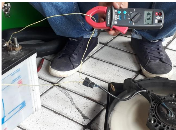
Gambar 18. Terukur Arus Sesuai Spesifikasi
