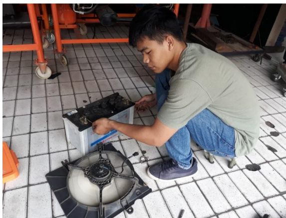
Gambar 11. Pemeriksaan Langsung Kinerja Kipas Pendingin
