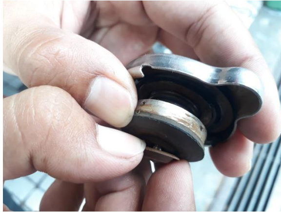
Gambar 6. Pemeriksaan Vaccum Valve Tutup Radiator
