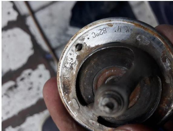
Gambar 8. Pemeriksaan Thermostat secara Visual
