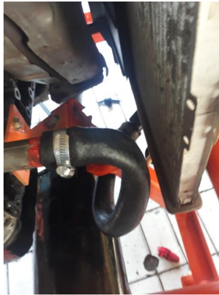
Gambar 14. Pemasangan Lower Hose Mitsubishi Colt T
