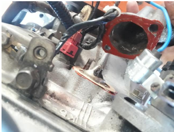
Gambar 13. Pemberian Sealer pada Rumah Thermostat
