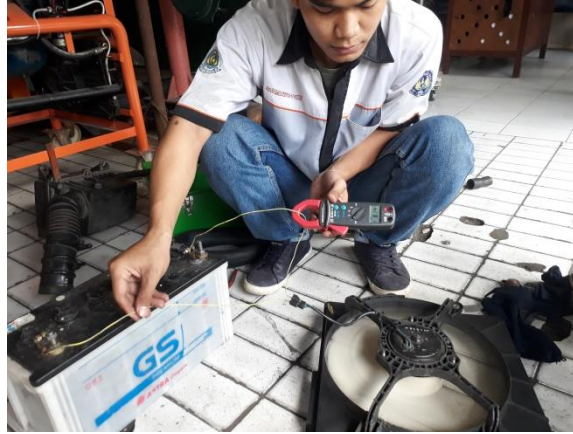
Gambar 12. Pemeriksaan Arus Kipas Pendingin dengan Amperemeter
