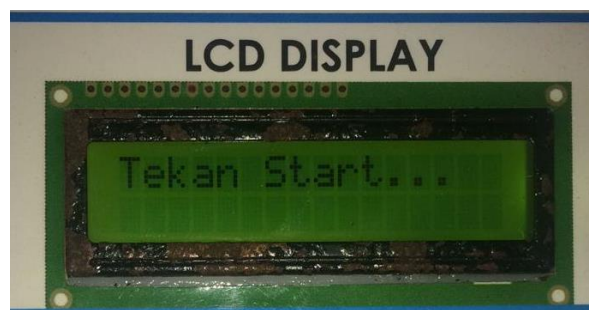
Gambar 26. Tampilan hasil pengujian LCD 16x2
