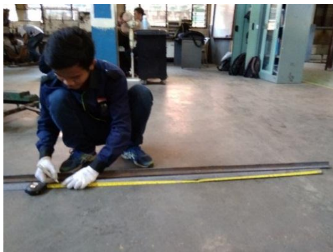
Gambar 32. Pengukuran panjang besi siku
