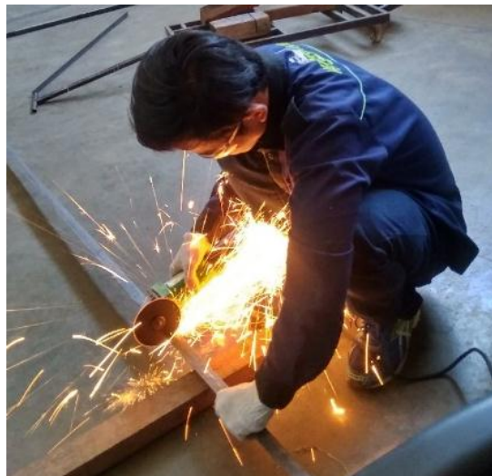
Gambar 33. Proses pemotongan besi siku
