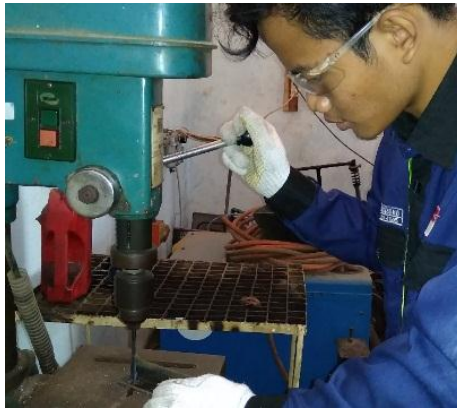
Gambar 34. Proses pengeboran braket rak
