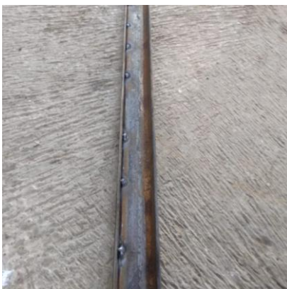
Gambar 36. Hasil pengelasan rak
